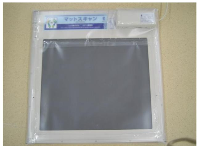
図2 防水処理を施した重心動揺測定器
