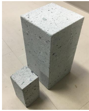
図4：実験評価に使用した供試体と圧縮強度の実験結果
